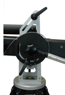
18. Steuerseil um Steuerscheibe legen / Wrap control cable around the disc
