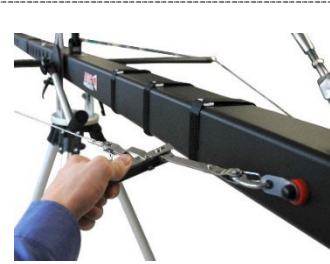
48. Spannschloss schließen / Close rod strainer of end segment no.4
