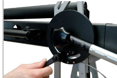
15. Fixierhebel für Krankkopfverstellung montieren / Mount lever for angle lever brake
