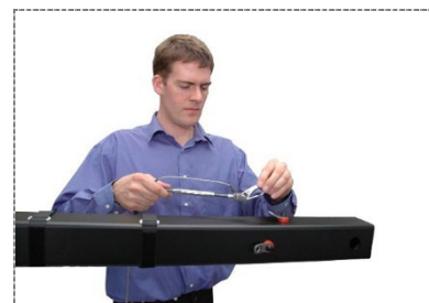
27. Turmseil mit Haken an Endsegment 4 einhängen/ Hook tower cable at the segment 4
