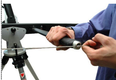
43. Klemmstück Abspannseil mit Outrigger verbinden / Connect rope (clamping piece) with outrigger
