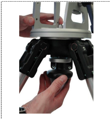
4. Sternschraube sicher anziehe/ Fix screw securely
