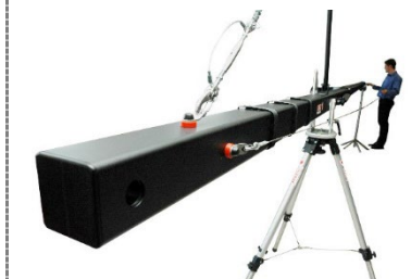
41. Abspannseil mit Kopfsegment ● verbinden / Take rope to top segment ●
