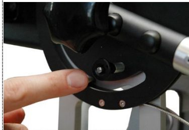
14. Druckpin in vorgesehene 0-Loch einführen (Krankkopf hält beim Schwenk Horizontposition (wichtig für Remote Head) / Stick pin in the recess for 0-Position
