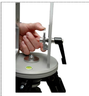
7. Kranbremse mit Abstand montieren/ Brake callipers with space for mounting of basic segment
