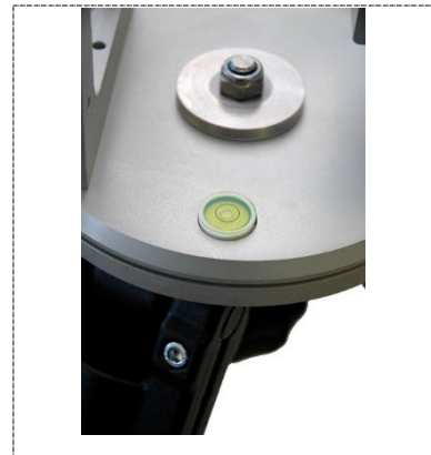
6. Stativ ausrichten – 0 Punkt/ Spirit level 0 point
