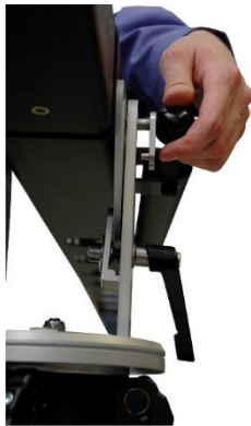
10. Rückseitig: Achsstift mit Pin in Buchse einführen / Fix axis pin in accurate position
