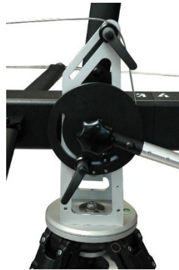
56. Umlenkrolle Steuerseil – Position sehr steile Krankopfwinkel / Deviation roller in position for extrem steeper angle motion
