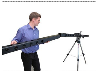
20. Verlängerungssegment 2 mit Basissegment 3 verbinden / Connect segment no.2 with no.3
