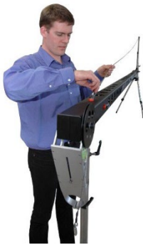
31. Turmseil zum Kopfsegment ● ziehen /Connect clamp with top segment
