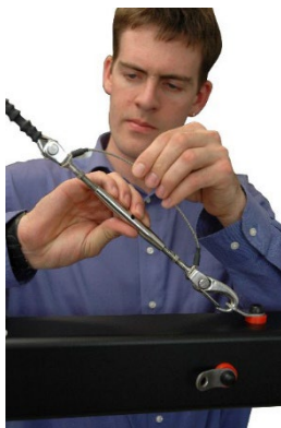
34. Durch Drehbewegung spannen, mit Muttern kontern/ Tighten the tower wire, fix with screw nut
