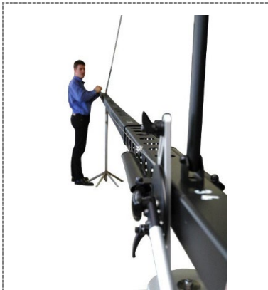
37. Steuerseil zum Kopfsegment ● ziehen / Take steering rope to the top segment
