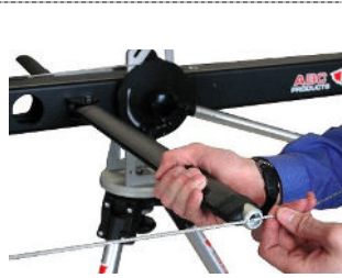
47. Klemmstück Seil mit Outtrigger verbinden / Mount rope (clamping piece) with outrigger
